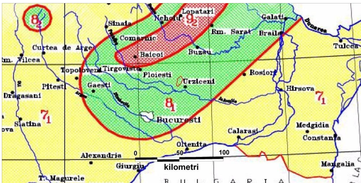
Figura nr. 15 - Macrozonarea seismică a României S.R. 11.100/1— 93
